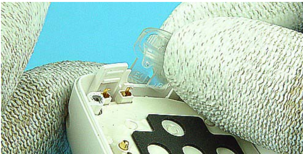
21) Pull out the Power Button .
